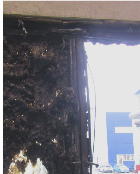
Figura C2.3 Foto del campione di prova CSI2416FR [8] in cui il fermavetro si è staccato dal telaio / Photo of the test sample of CSI2416FR [8] in which the glazing bead came off the frame
