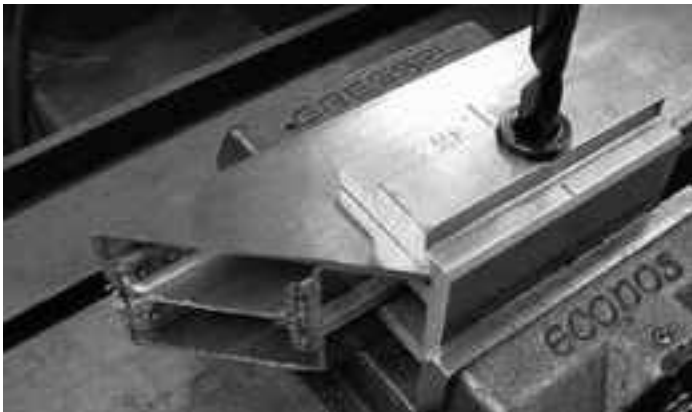
Bohren mit Ständer-Bohrmaschine Perçage des trous avec perceuse verticale Drilling using upright drilling machine
