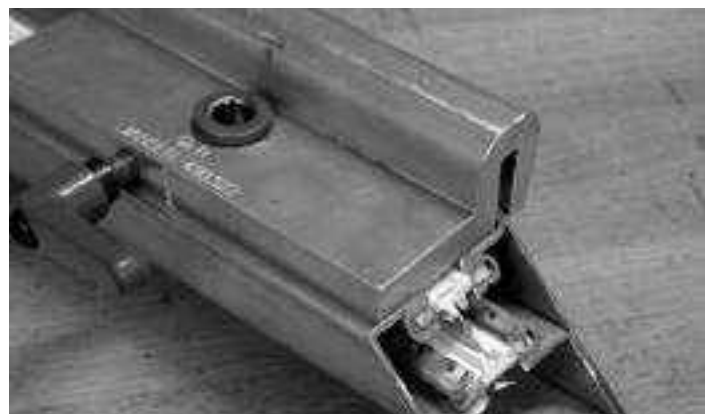
Lehre positionieren und anklebmen Positionner le gabarit et le serrer Locating and fixing the jig
