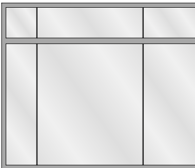
Stoßfugenverglasung Vitrage joint vif Butt-joint glazing
